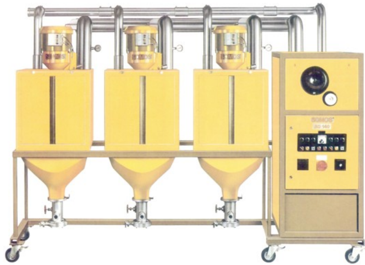
Bild 23: Mehrere Granulatbehälter werden von einem Trockenluftheizer gespeist.
