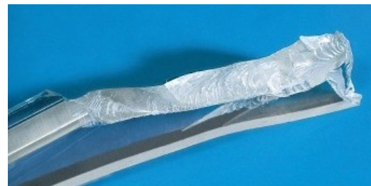
Abbildung 2: Spröde gebrochenes Formteil aus hydrolytisch abgebautem Material.
